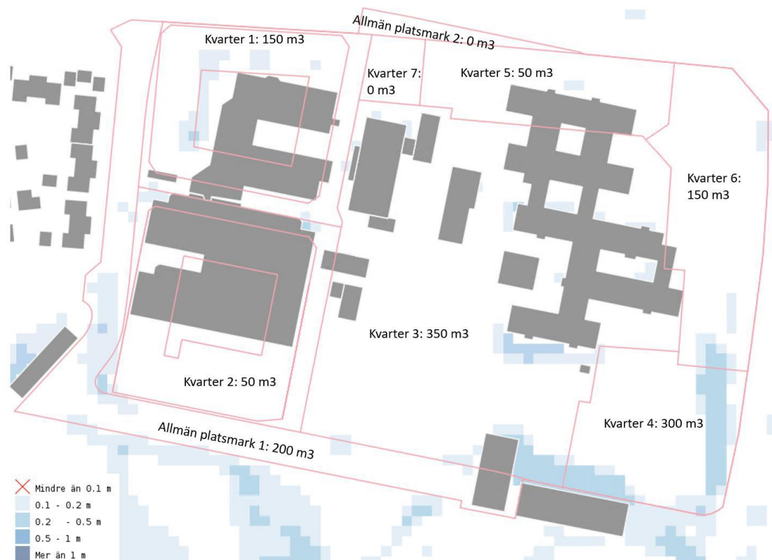
Figur 12. Blå områden visar vattendjup vid skyfall i området. Mörkare blå färg innebär större vattendjup. För vattensamling framgår vattendjup samt volym. Vattendjupet varierar 0,1–0,5 m med störst vattendjup längs sydöstra plangränsen (kvarter 4). Illustration: Fredblad arkitekter, bearbetad av kretslopp och vatten
