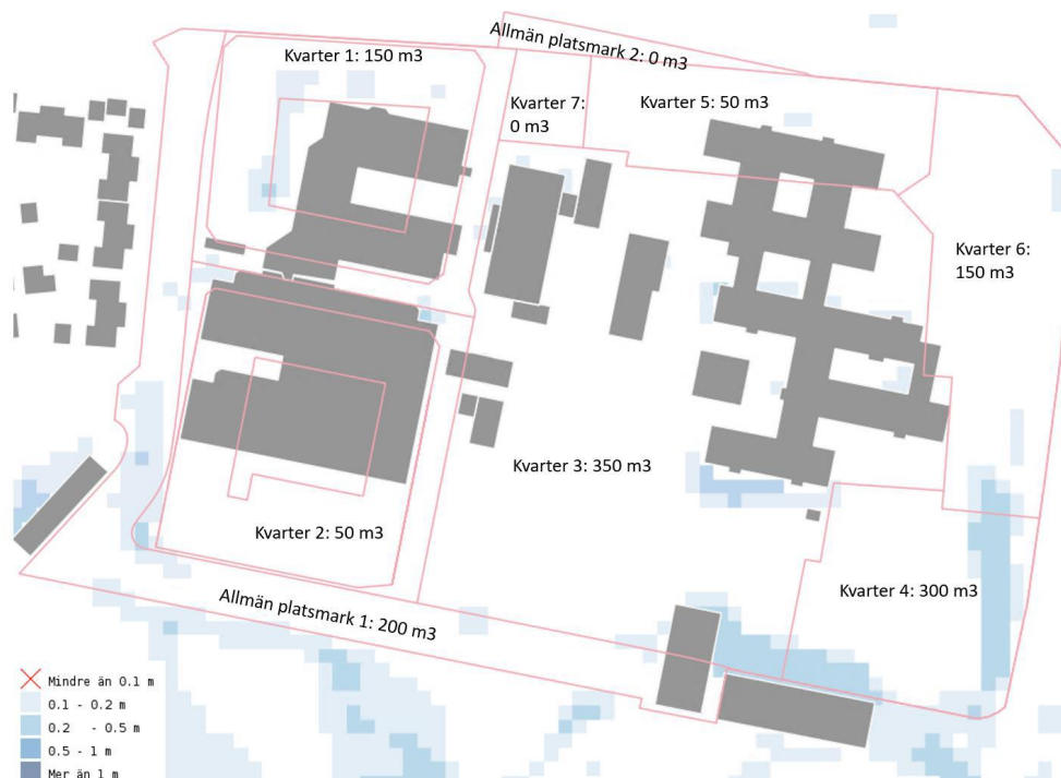
Figur 49 Blå områden visar vattendjup vid skyfall i området. Mörkare blå färg innebär större vattendjup. För vattensamling framgår vattendjup samt volym som behöver omhändertas inom respektive kvarter. Vattendjupet varierar 0,1–0,5 m med störst vattendjup längs sydöstra plangränsen (kvarter 3, 4 och 6).
